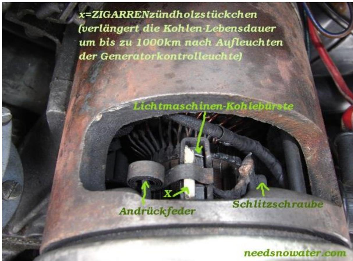
Diese Schraube wird nun losgeschraubt und vorsichtig rausgenommen, damit die nicht in den Innereien der Lichtmaschine verschwinden kann. (Im Idealfall würde sie sonst auch unten rausfallen). Hat man nun die Schraube gelöst, und in Sicherheit gebracht, drückt man die Feder nach oben/zur Seite, zieht die Kohlebürste raus und setzt die neue Kohlebürste rein und schraubt die Kabelöse an.
